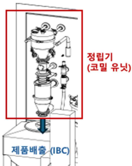
그림 3.2.P.2.3-17 연속제조를 위한 정립 공정의 코밀(co-mill) 유닛 및 제품배출 경로
