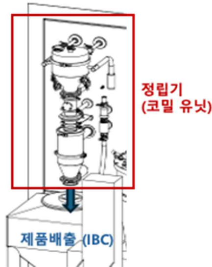
[그림 3-14] 연속제조를 위한 정립 공정의 코밀(co-mill) 유닛 및 제품배출 경로
